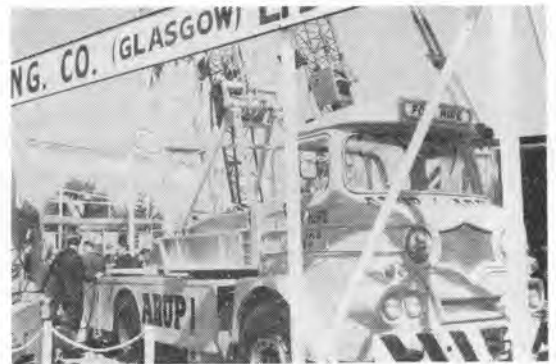
写真-8 ラムパートのハイドロコン・ハイランダ型 6 t 油圧式トラッククレーン ドライブのシートを後方に回わしてクレーン操作時のシートとする (ロンドン展示会)。
