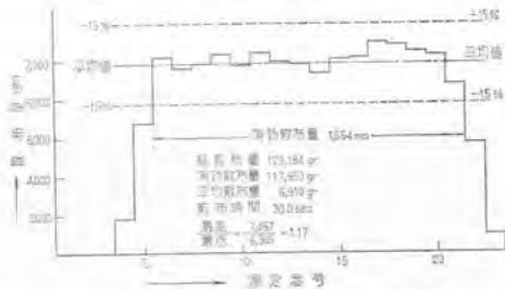
図-22-1 日本フレキ DR-18 型 (標準幅) 停車時散布量分布試験結果 (アスファルト乳剤 PK-1)
