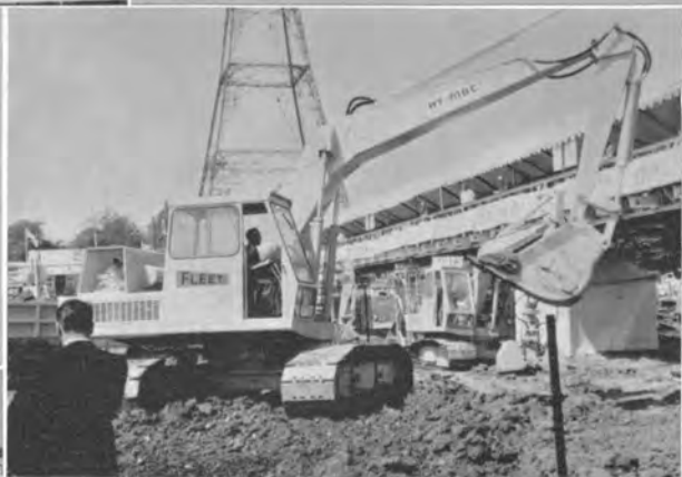
↑ハイドロリックマシーナリ社のハイマック 1080型全油圧バックホウ。1m 3 , 165PS, 22t
