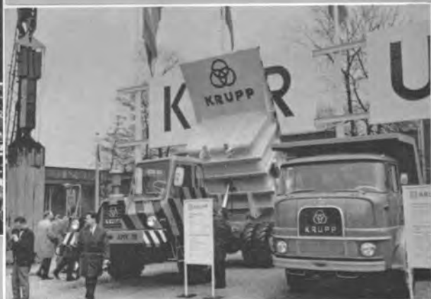
↑クルップのダンプトラック 左は 4×4 20t、12m 3 積 220HP 総重量32.87t 右は 11t、7.2m 3 積 205HP
