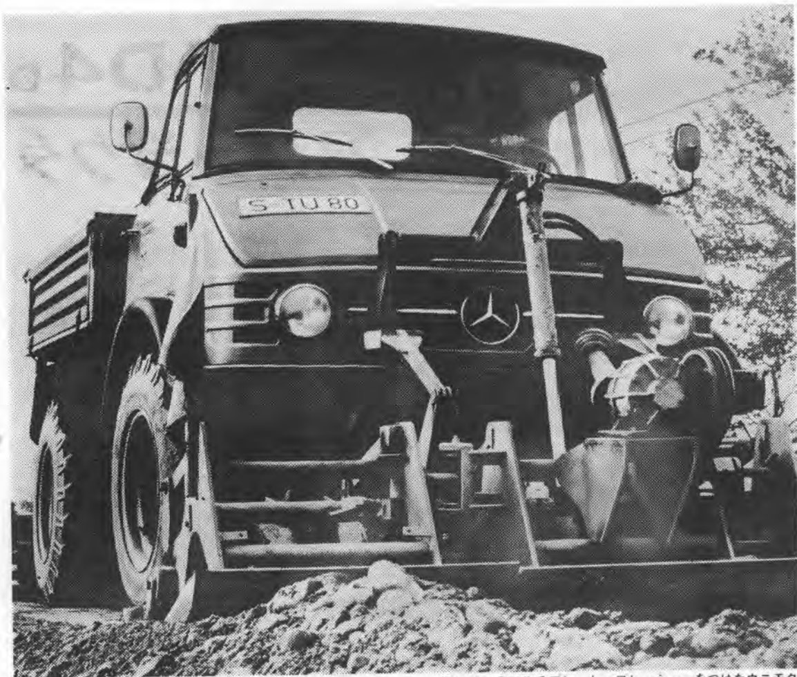
幅2.43mのマルチプレート・フレッシャーをつけたウニモク
