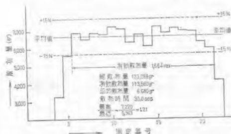
図-22-2 日本フレキ DR-18 型 (標準幅) 停車時散布量分布試験結果 (カットバックアスファルト MC-2)
