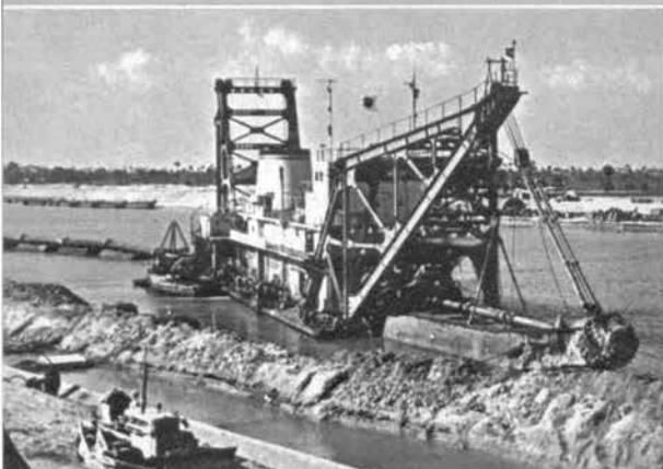
↑ポンプ式しゅんせつ船“スエズ号” 5,000HP、1,500m 3 /h
