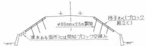
(b) コンクリート格子わく工全面防護区間
