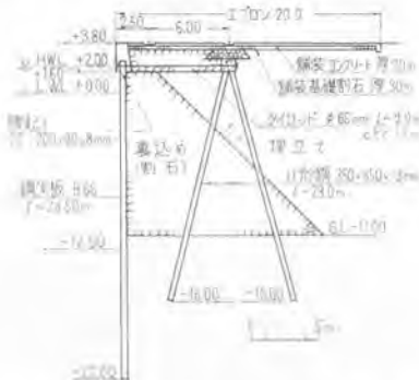
図-8 30号、31号バース標準断面図
