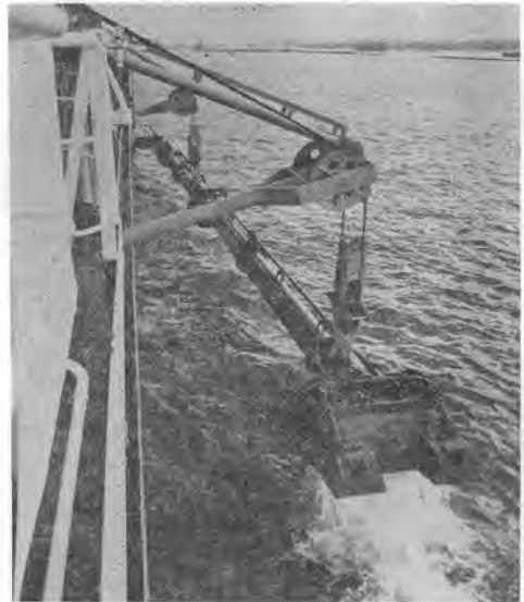
写真-3 ドラグアームとドラグヘッドを海中から引上げたところ
