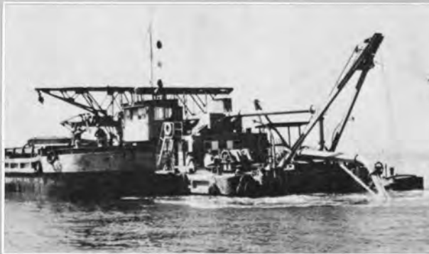
→ カッターレス船による敷砂採取 鋼 215 t ディーゼル 350HP 600m 3 /hr 採取
