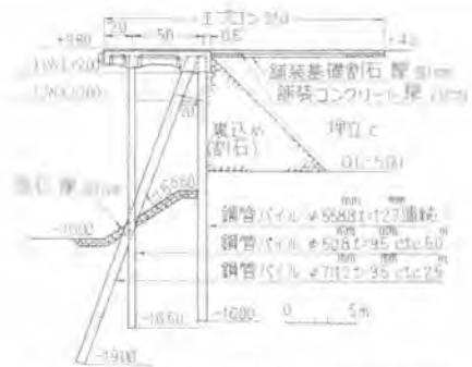
図-9 18号、25号、26号バース標準断面図
