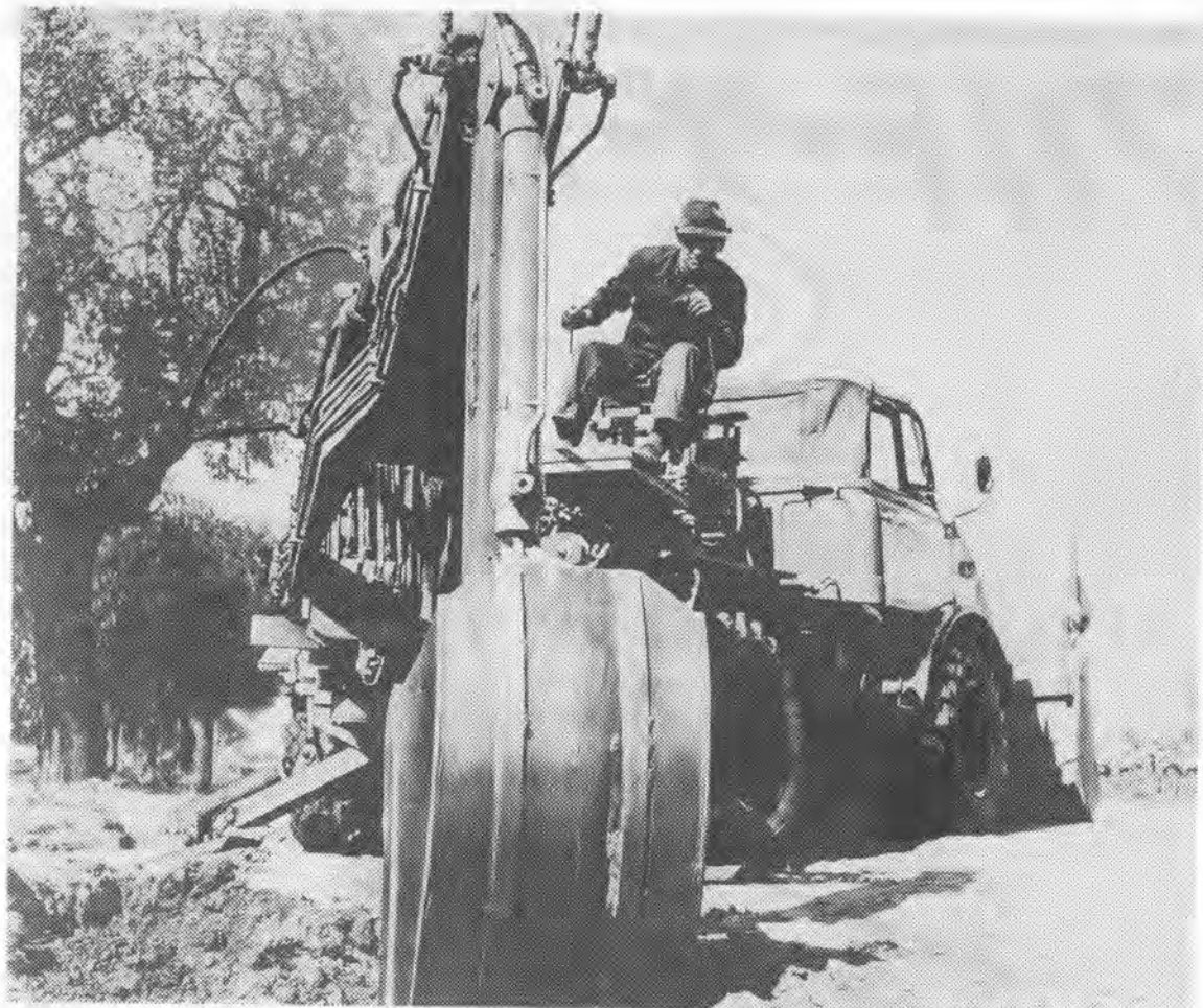
前に取り付けけたバケットは理想的な掘さく機になります
