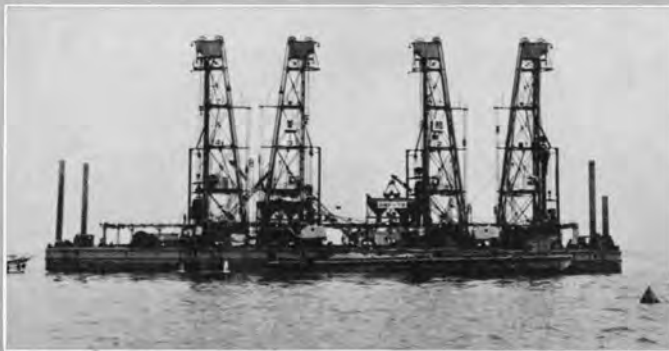
↑ 大型砂ぐい打込み船「蒼竜」(吃水 1.3 m 長さ 70 m 幅 20 m)
