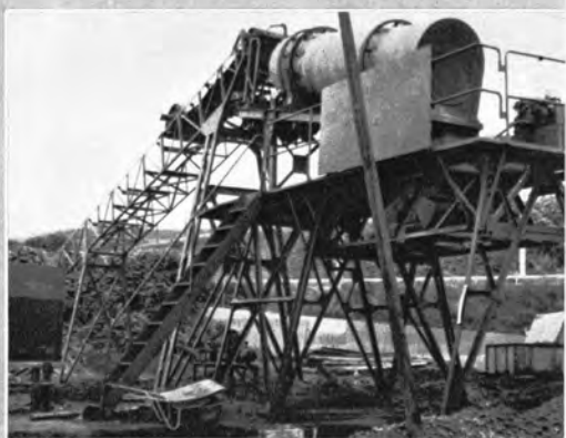
↑ こうさい 鉱滓と山砂を混合するロータリドラム式のプラント (150 t/hr)
