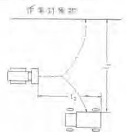
図-38-1 積込み作業試験時の車両配置図
