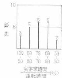
図-12 0.6 m³ 級パワーショベルの実作業時間率(短期調査)
