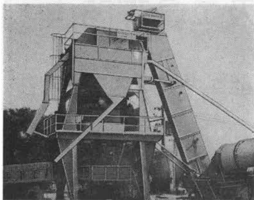
上図：稼働中のH-253型、4000ポンド パッチプラント最高144TPH以上のプラント
