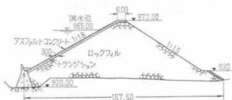
図-11 大津岐ダム標準断面
