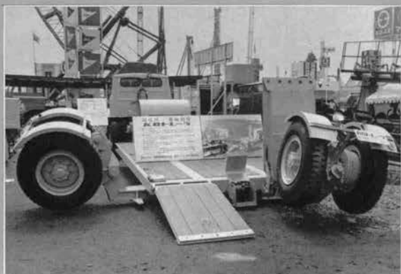
↓積み込みの容易な超低床式トレーラ
