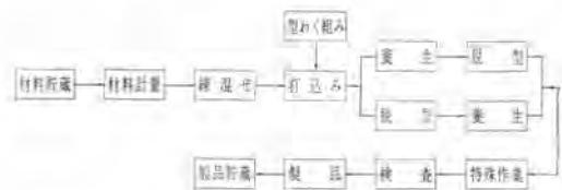
図-1 プレキャストコンクリート工場の作業工程
