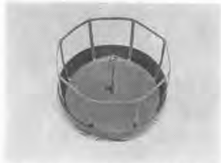
写真-5 トレミー工法に使用するプランジャ
