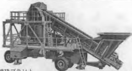
■可搬式破砕プラント
