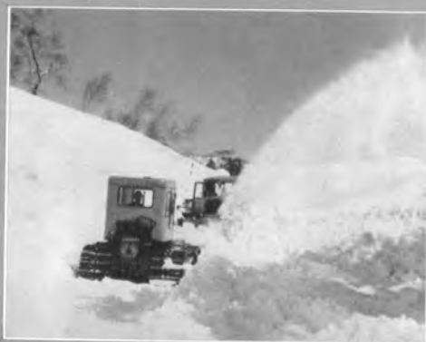
中山峠付近は標高830mで4～6mの積雪量がある。この除雪にはブルドーザで雪寄せし、ロータリ車ではねとばす方式がとられている。雪は6月上旬まで残り、道路工事は除雪作業から始められる。
