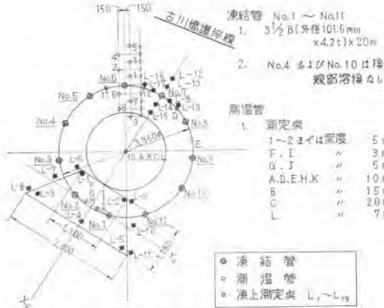
図-7 深礎凍結配置図
