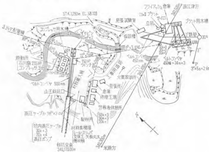
図-5 第2工区坑外設備図
