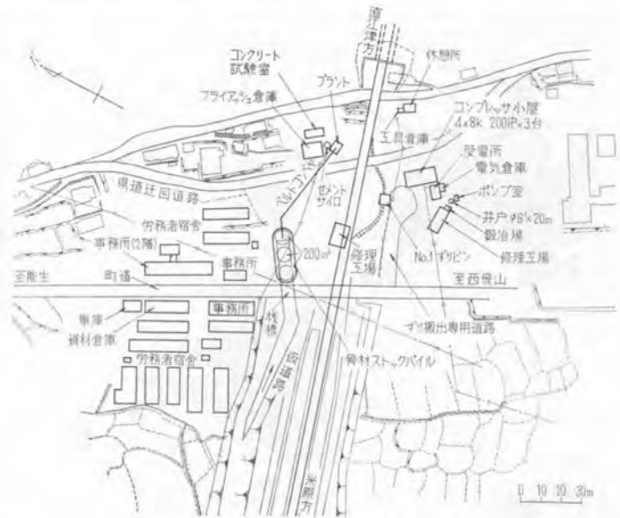
図-4 第1工区坑外設備図
