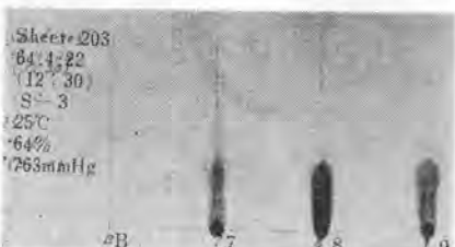
写真-5 BB-11ブルドーザの簡易ペーパークロマトグラフィ B...新油 7...50 hr 8...100 hr 9...150 hr
