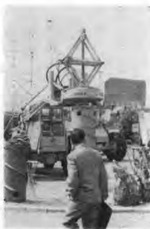
写真-13 パリ公共土木施設展(2) 大口径ボーリング機械
