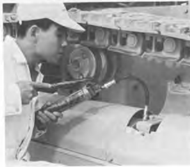
— 履帯調整は簡単な油圧式 —
