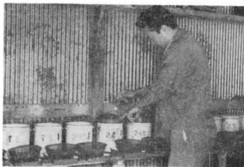
写真-5 浮沈テスト状況
