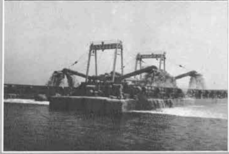
↑プッシュバージ：積載量 850m 3 (備讃瀬戸航路浚渫土をバージに積み込み中)
