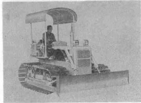
写真-2 古河の小型湿地ブルドーザ
