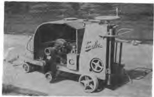
写真-72.1 平坦性試験場の精機 RD-42 MS-300 型ロードドレッサ
