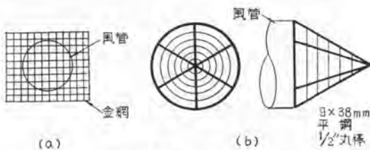
図-3 風管の飛石保護装置
