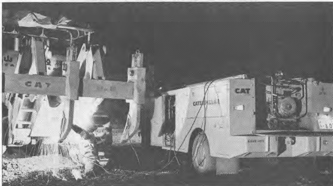
リッパ ツースの肉盛り溶接作業
