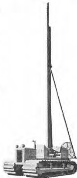
写真-1 ペーパドレーン打込機
