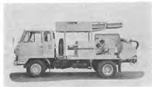
写真-3 コンクリートポンプ車
