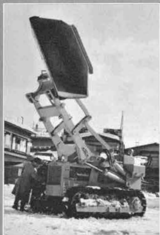
トラクタショベル NTK-4 サイドダンプ式
