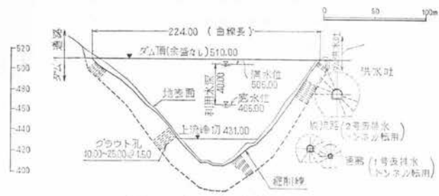
図一2 ダム上流断面図
