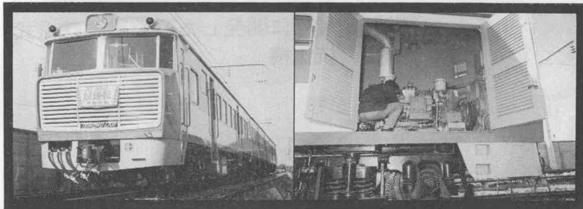
中米ニカラグア向けディーゼルカーに 搭載のCAT D333TA
