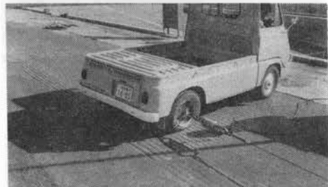
写真-6 ロードドレッサによりアスファルト舗装版上に溝を切った場合の車輪の摩擦係数測定
