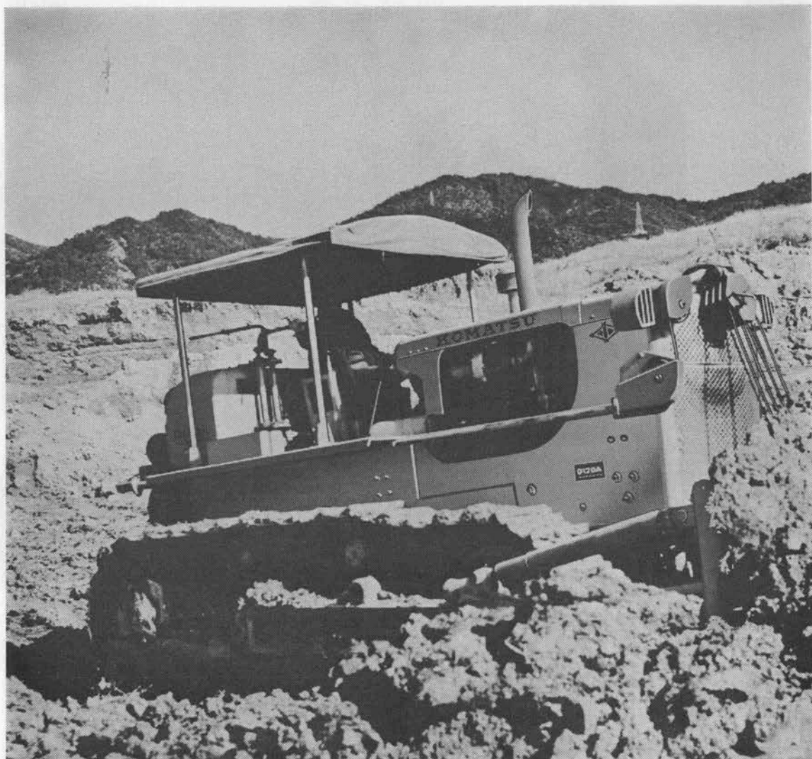
ケーブル式 整備重量26,850Kg 機関出力250PS
