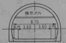
トンネル区間標準断面図 1/300
