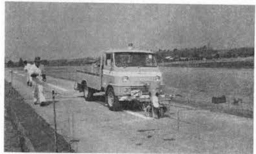
写真-83.1 作業試験中の日本フレキ工業 LM-107 型 ラインマーカ
