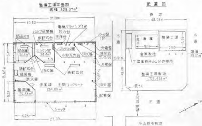
図-1 工場の配置と設備
