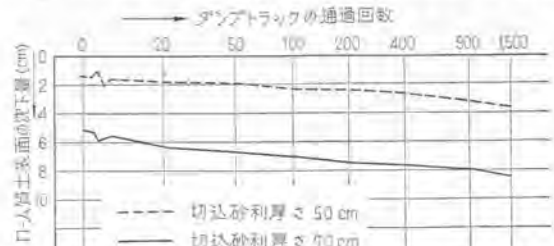
図-6 ダンプトラックの通過回数とローム質土表面の沈下量との関係
