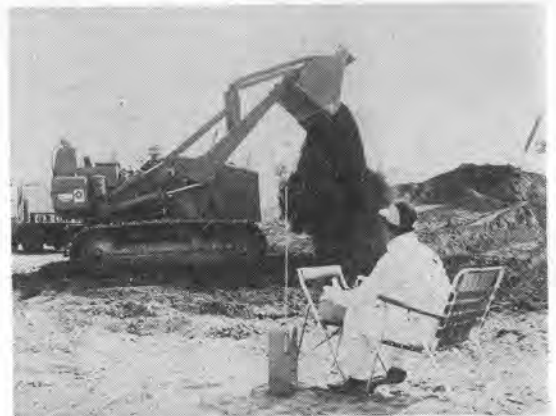
写真-2 リモートコントロール装置付トラクタショベル
