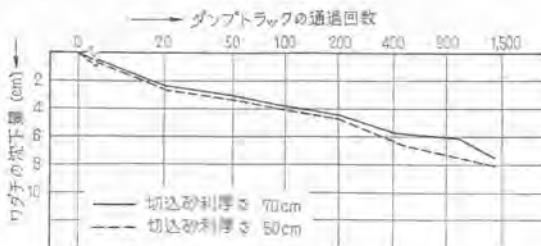
図-5 ダンプトラックの通過回数とわだちの沈下量との関係
