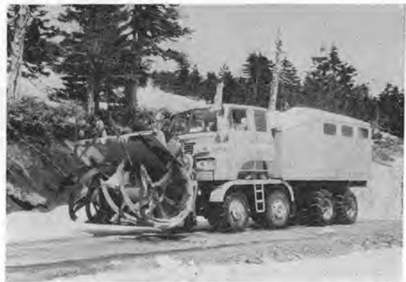
写真-6 HTR-300型ロータリ除雪車(日本除雪機製)
