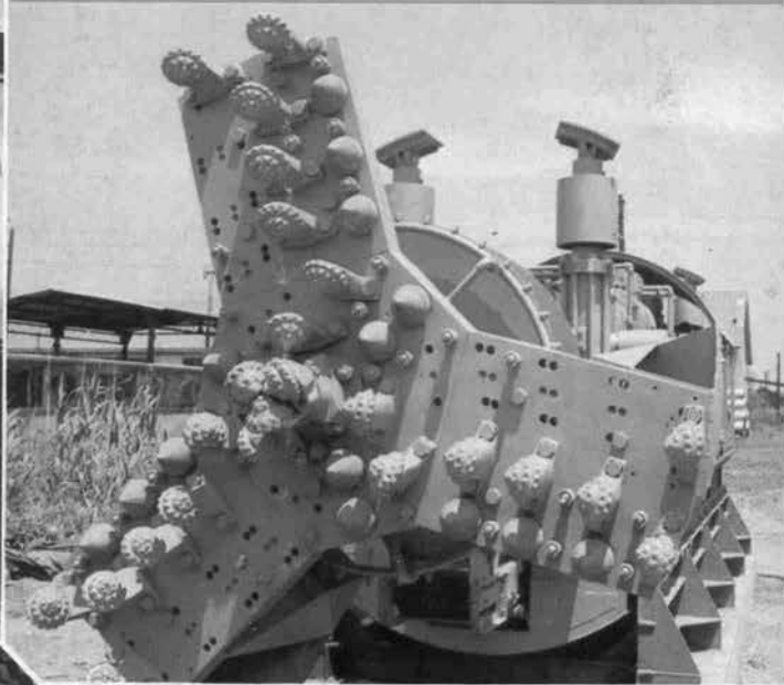
▼資技試II型全断面掘さく機 —工業技術院資源技術試験所—
