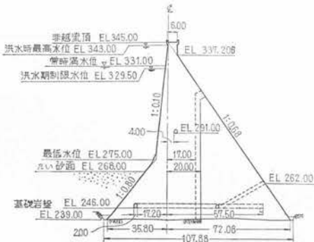
図-1 非越流部標準断面図
