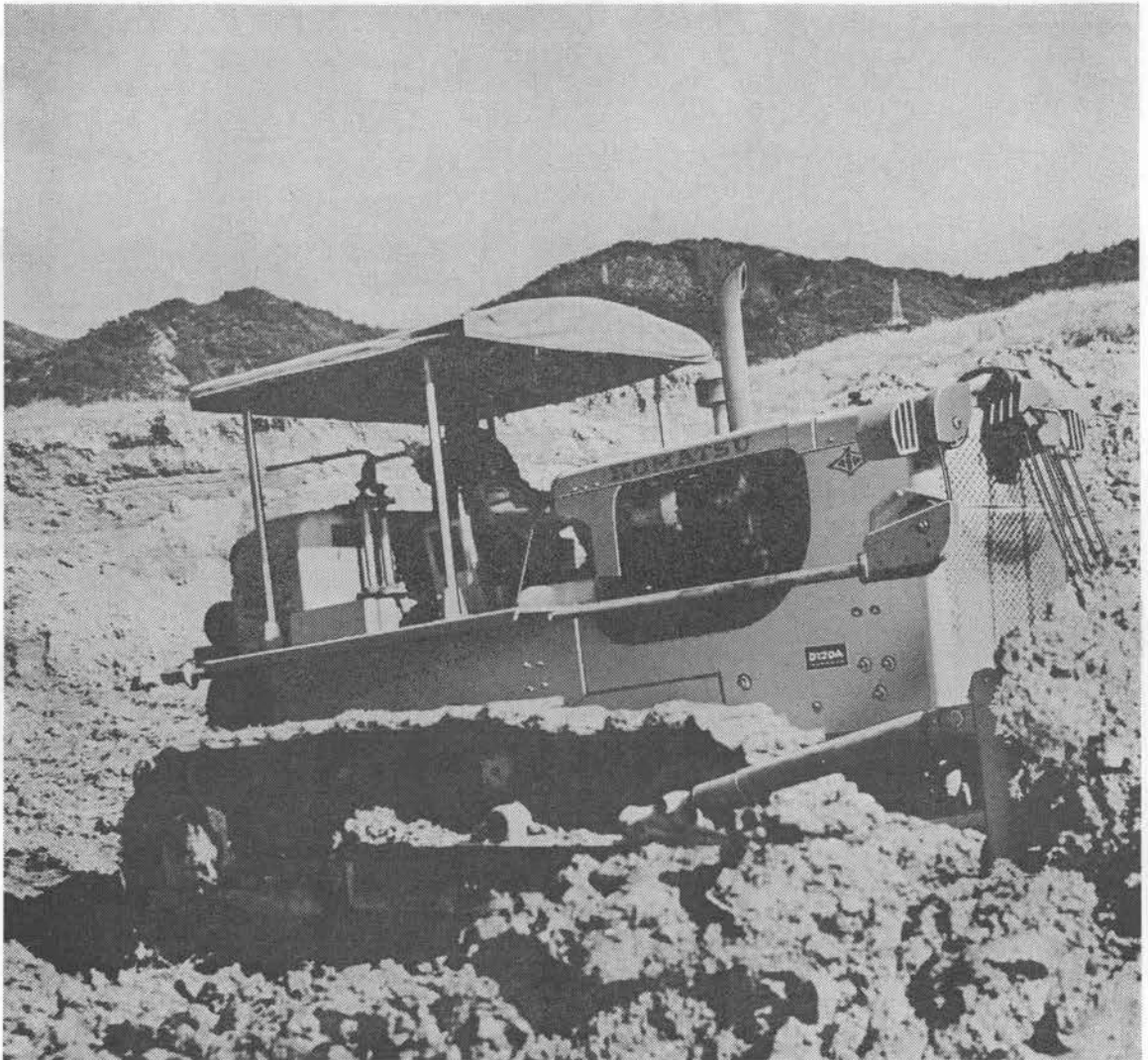
ケーブル式 整備重量26,850Kg 機関出力250PS
