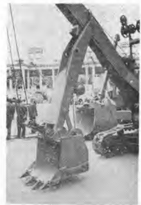
写真-22 ブームを上下して押し出し、引込みするショベルフロント (ソ連)
