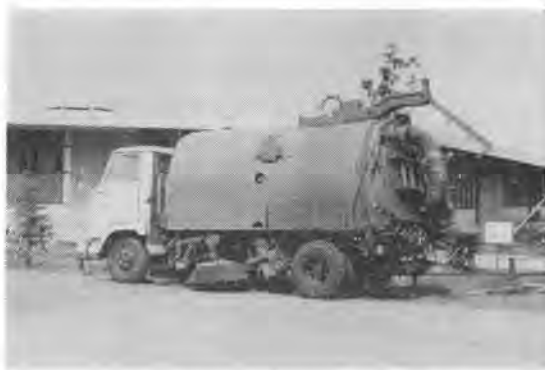
写真-1 東急 SV-1 形真空吸込式路面清掃車
