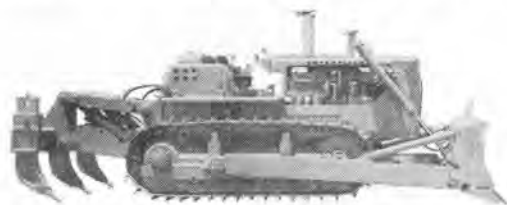
写真-5 CAT D8H ストレートドーザ (リッパ付)
