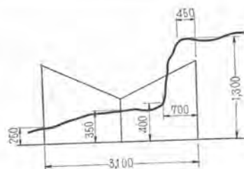
図-4 Vプラウによる除雪状況
