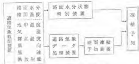
図-7 路面凍結予知器機構図
