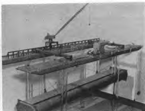
写真-3 双胴バージによるセクション沈設の模型
