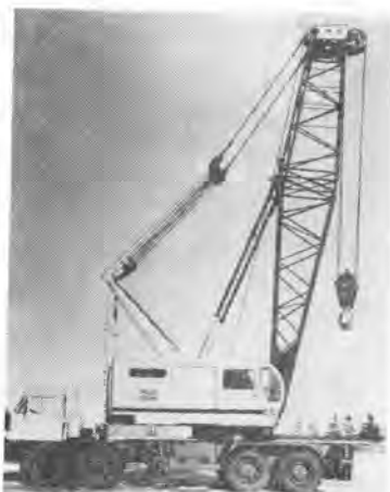
写真-1 P & H 9125 TC トラッククレーン
