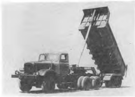
写真-19 昭和 38 年製作 日野 20 t 積ダンプトレーラ テレスコピックホイス付
