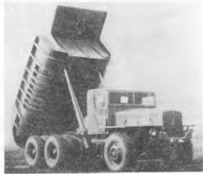
写真-8 昭和18年製作 国産重ダンプトラック第1号車 いすゞ TH 10 形 20t積 総重量 37t ディーゼル自動車工業製
