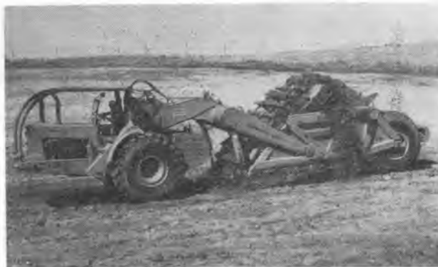
写真-3 ルターナ社エレベータースクレーパー (WABCO 31 yd 3 )
