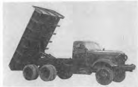
写真-21 昭和 38 年製作 日野 ZC 44 形 10 t 積リヤダンプ ダブルホイス付
