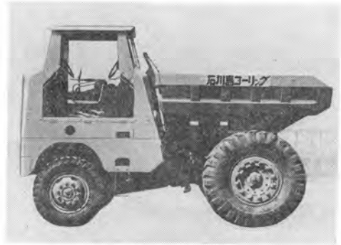
写真-16 昭和 30 年製作 石川島コーリング製 60-2A 形 7.5t 積シャトル オペレーション (写真は昭和 42 年のもの)
