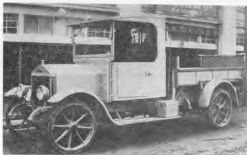
写真-1 大正 12 年製作 東京石川島造船所自動車部製ウーズレー DPC 形 1.5 t 積 犬塚製作所架装 単段垂直式ホイスト シリンダ機構の上部が天秤つり上げ式となつて ワイヤロープで荷箱の上げ下げを行なう
