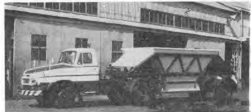
写真-22 昭和 42 年製作 15 t 積ホップトレーラ 川西モーターサービス製
