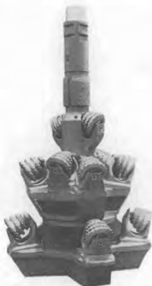
直径 1.5M レイズボーリングビット ザンビア銅山デ、圧縮強度 3,200kg/cm 2 ノ硬岩ヲ掘削シマシタ。
