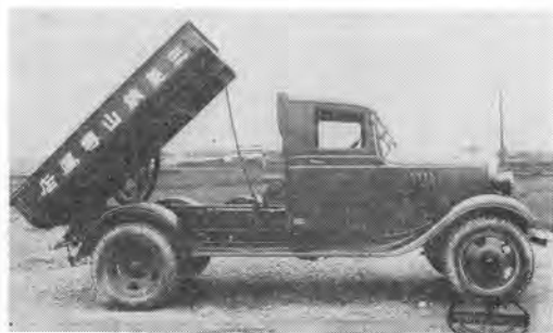
写真-3 (a) 昭和 7 年製作 東邦特殊自動車製(現東急車輛製造) 2 t 積カム式ホイスト機構使用
