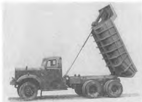
写真-20 昭和 38 年製作 日野 ZC 形 10 t 積リヤダンプ テレスコピックホイス付
