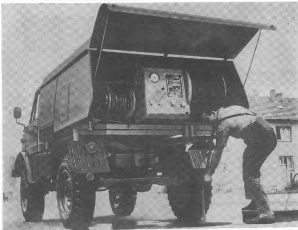
ユニモクの荷台に架装した給水タンク付高圧噴射洗浄装置 タンク容量1000ℓ
