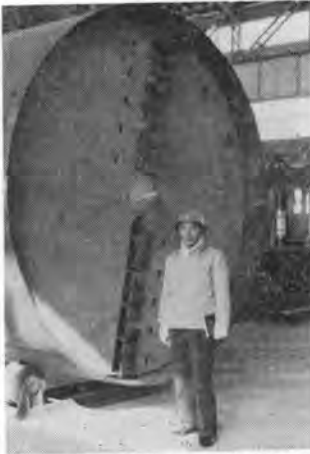
写真-1 泥水加圧式機械化シールドの前面カッタ部分
