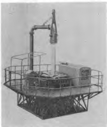
写真-15 カトウ RAC-200 KC 形アースドリル
