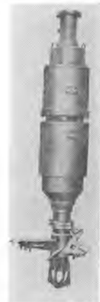
写真-20 利根 BH リバースサーキュレーションドリル RC-5 形
