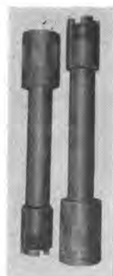
写真-2 ドリルロッド
