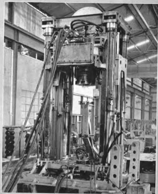
アメリカヒューズのレーズボーラ 住友金属鉱山機で活躍中 掘削形式：導孔切上げ、拡孔切下げ
