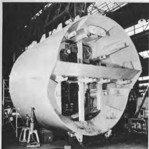
東京都浮間幹線下水道用シールド(径4.54)
