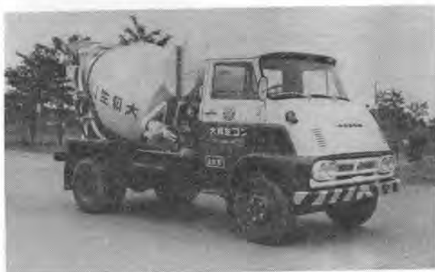
写真-4 1.7 m 3 中形定回転装置付トラックミキサ ((株)新潟鉄工所製)
