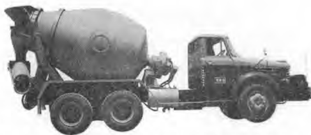
写真-5 低速高トルクモータ付 4.3 m 3 車 (川崎車輛(株)製)
