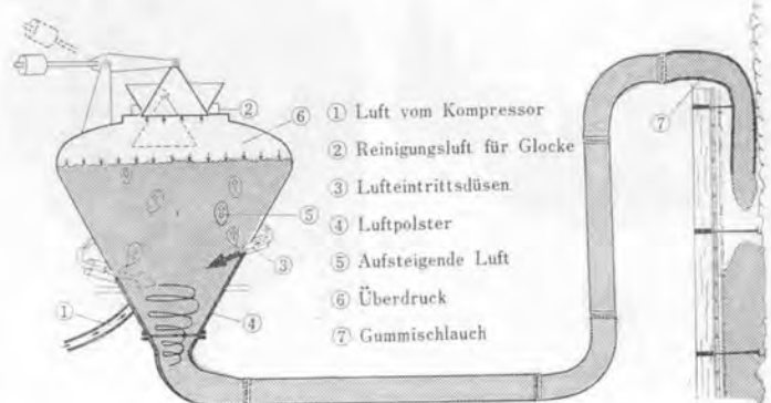
図-1 バランス圧送方式のコンクリートブレーサ
