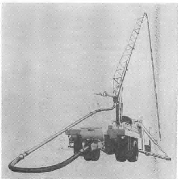
写真-4 トムセン 640 形ブーム付コンクリートポンプ車外観
