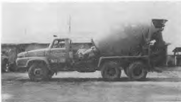
写真-1 4.5\text{ m}^3 油圧駆動トラックミキサ (新明和工業(株)川西モーターサービス製)
