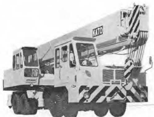
写真-1 カトウ NK-32 形全油圧式トラッククレーン
