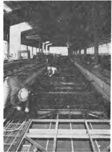
写真-8 製造ライン上の作業(配筋)
