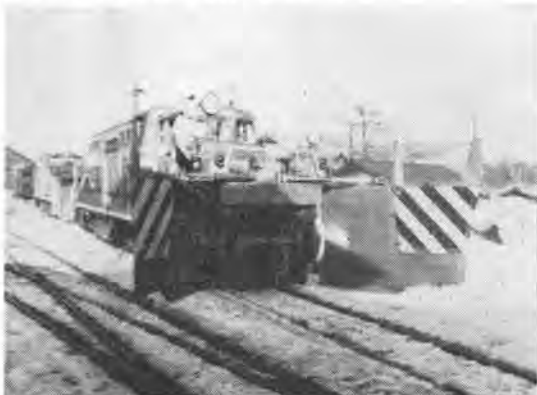
写真-2 2,000 PS のエンジンで駆動される DD 53 形ディーゼルロータリ除雪車
