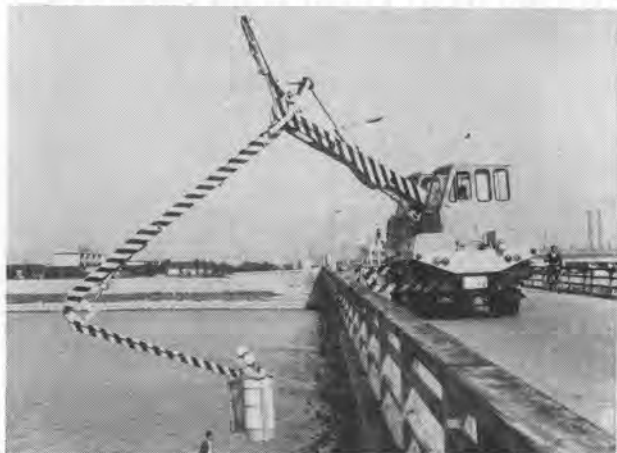
写真-7 橋りょう点検車（新明和川西モーターサービス）
