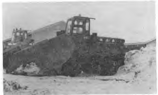
写真-9 ホイール式除雪車（東洋運搬機）
