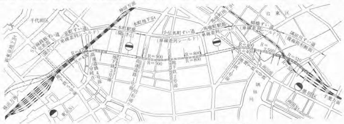
図-1 総武線線増(東京両国間)線路平面図
