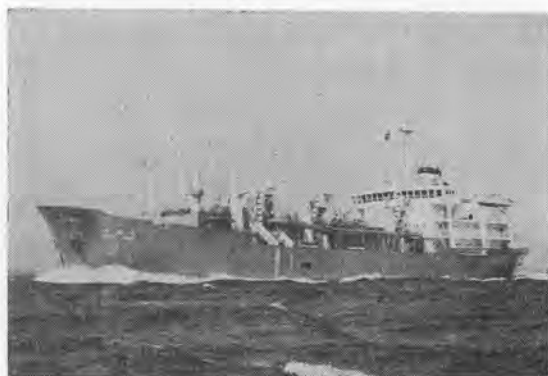
写真-5 ドラグサクシヨン浚渫船「海鵬丸」
