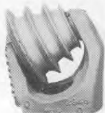
直径 1.5M レイズボーリングビット ザンビア銅山デ、圧縮強度 3,200kg/cm 2 ノ硬岩ヲ掘削シマシタ。
