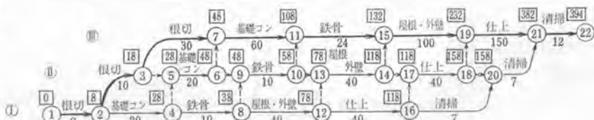
図-4 ① → ② → ③ の施工順序によるネットワーク (□内は EST)
