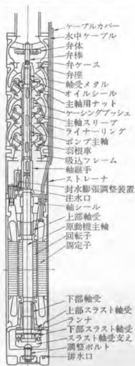
図-1 水中モータポンプ構造図
