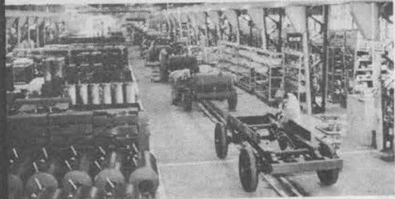
●200米コンベアラインの組立工場
