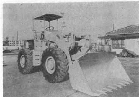
写真-3 2 m 3 トラクタショベル “SDA-50”
