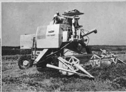
↑コンバインクレーソンM135による稲の 刈取り (100PS、刈幅4.50m)
