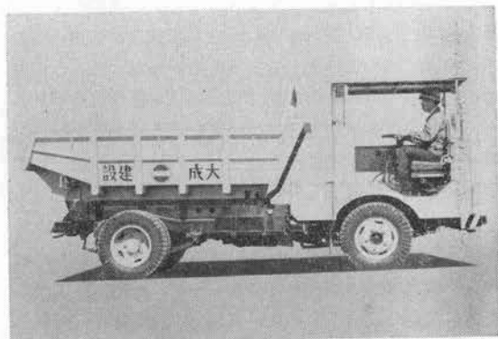
写真-2 TD1 形トンネルダンプカー後進走行
