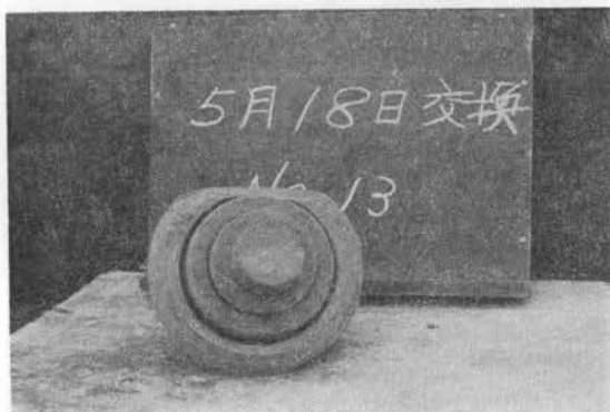
写真-5 偏摩耗したディスクカッタ
