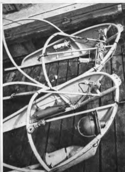
↑ピンポン・ホールを利用した深海底層流 測定装置(10,000mの深さまで使用可能)
