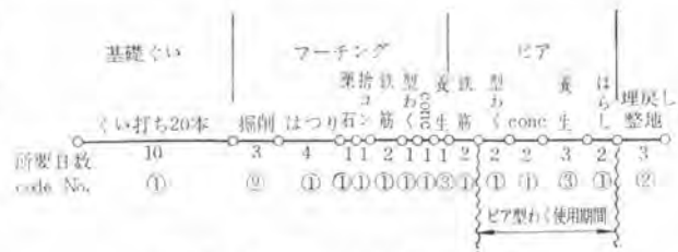
図-3 下部工詳細矢線図(1サイクル)
