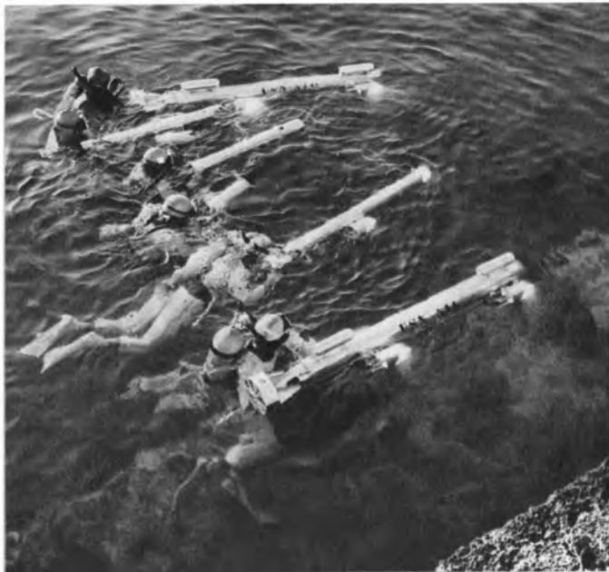
↓ 1人乗りの水中飛行機(70~80m潜水可能)
