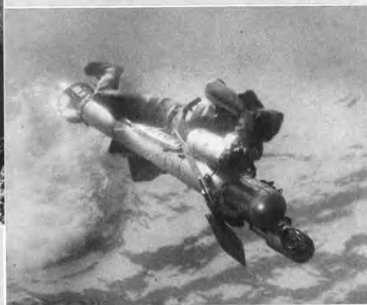
↓ 1人乗りの水中飛行機(70~80m潜水可能)
