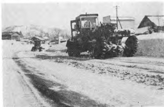
国道7号線能代工事事務所管内における氷 盤破碎装置付除雪グレーダでの氷盤除去と 除雪グレーダの併用作業による路面修正
