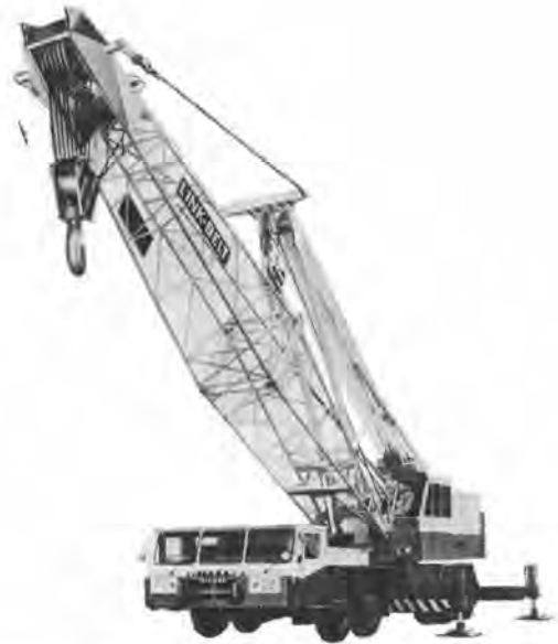
写真-1 HC-218 J トラッククレーン(つり上げ能力 75 t) 日産 8 TVW 70 C キャリヤ 架装
