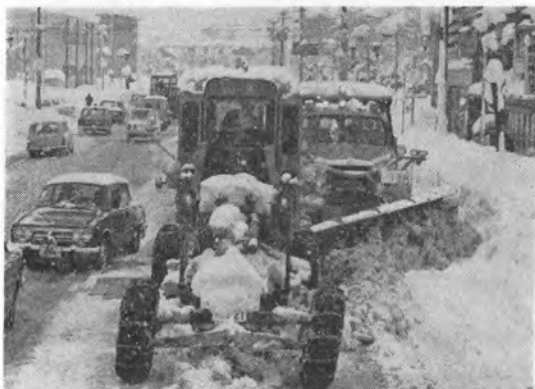
国道8号線富山市内で路面整正作業中の除雪グレーダ および除雪トラック
