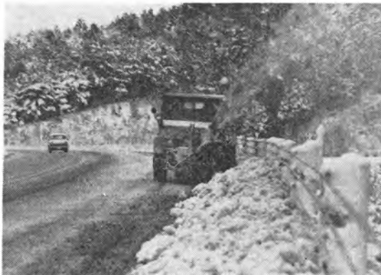
車道部除雪後路肩に寄った雪を排雪中のウニモグ・ スノーカタ 飛雪 約 30 m 運行速度 約 10 km/hr
