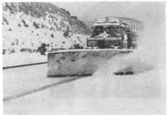
除雪兼薬品散布車（いすゞ TD 70） 機関 125 PS 除雪幅 3.45 m 除雪速度 30~50 km/hr 薬品積載量 2~3 t
