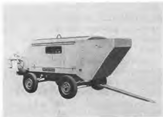
写真1 減音対策のなされたコンプレッサ
