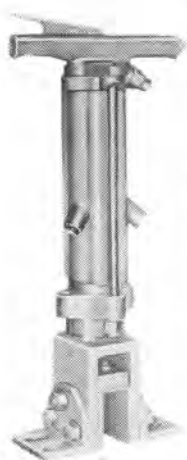
■シートパイルドライバー
