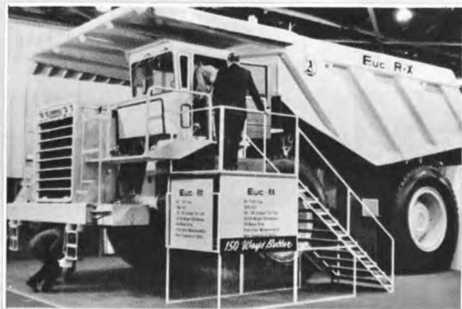
↑ 超大型のダンプトラック (Euclid RX形 105t)
