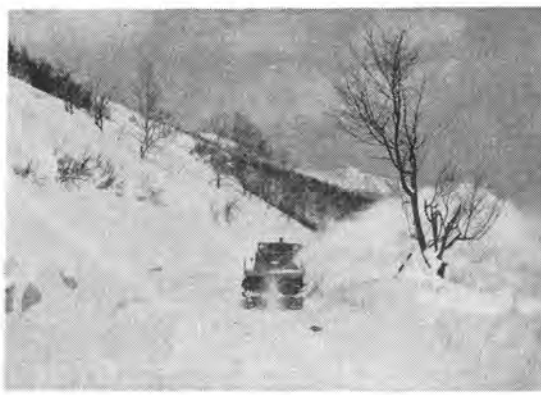
国道 38 号線狩勝峠におけるウニモグ川崎ロールパ形ロータリ除雪車による除雪作業
