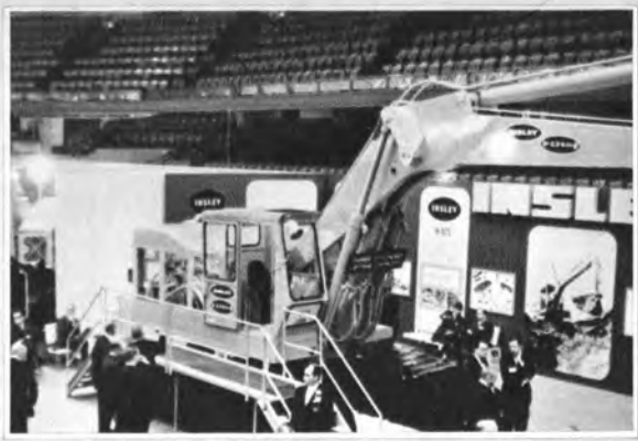
↑操縦性をよくした油圧バックホウ (Insley H875)
