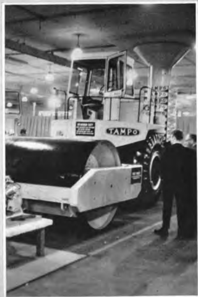
↑油圧駆動コンバインドローラ (Tambo RS410形)
