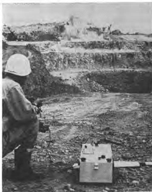
写真-1 三成分地震計による振動測定
