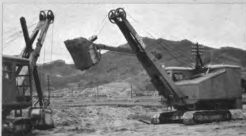
上：油谷 24-B III 形ショベル デイックバ容量 0.6m 3 昭和34年製 左上：油谷 24-D 形ショベル デイックバ容量 0.6m 3 昭和43年製 左下：油谷 24-A 形ショベル デイックバ容量 0.5m 3 昭和24年製
