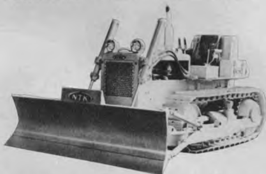
↑日特NTK-5形アングルドーザ 8.2t 昭和44年製
