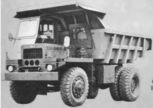
↑日野ZG13形 13.5t積ダンプトラック 昭和44年製
