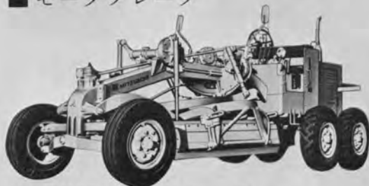
↑三菱MG3-M形モータグレーダ 9.0t 110PS 昭和44年製
