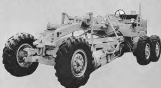
↑三菱LG2-H形モータグレーダ 11.25t 115PS 昭和44年製
