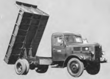
左：いすゞTX 352形 5t積ダンプトラック 昭和34年製
