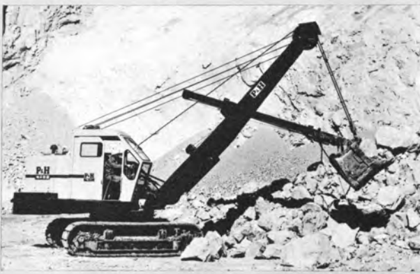
上：神鋼 P & H 315 形ショベル デイックバ容量 0.6m 3 昭和44年製 右上：神鋼 15-K 形ショベル デイックバ容量 0.4m 3 昭和24年製 右下：神鋼 P & H 225 A 形ショベル デイックバ容量 0.6m 3 昭和32年製
