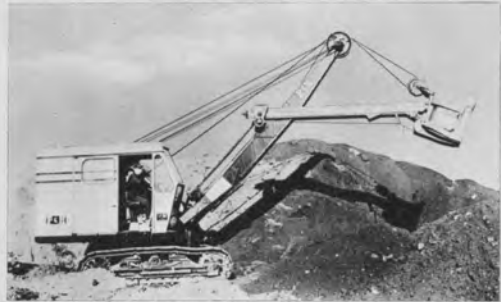
上：神鋼 P & H 315 形ショベル デイックバ容量 0.6m 3 昭和44年製 右上：神鋼 15-K 形ショベル デイックバ容量 0.4m 3 昭和24年製 右下：神鋼 P & H 225 A 形ショベル デイックバ容量 0.6m 3 昭和32年製
