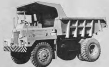
左：日野ZG12形 11t積ダンプトラック 昭和34年製
