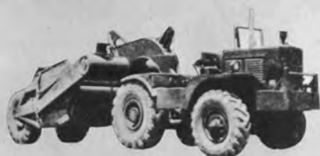
↑日特NTK-5形アングルドーザ 8.2t 昭和44年製
