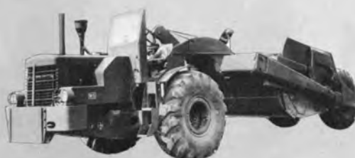
← 三菱MS形モータスクレーバ 20t 180PS 昭和32年製
