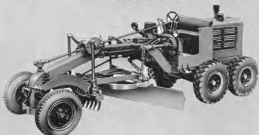
↑三菱MGII形モータグレーダ 8.2t 60PS 昭和25年製
