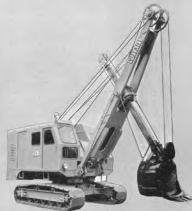
上：油谷 24-B III 形ショベル デイックバ容量 0.6m 3 昭和34年製 左上：油谷 24-D 形ショベル デイックバ容量 0.6m 3 昭和43年製 左下：油谷 24-A 形ショベル デイックバ容量 0.5m 3 昭和24年製
