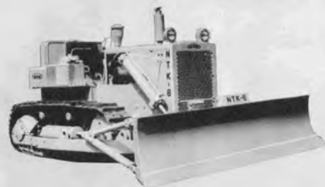
↑日特NTK-6形アングルドーザ 12t 昭和34年製
