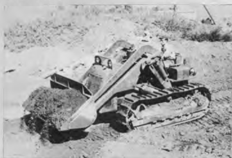
日特NTK-4形トラクタショベル 8t 山積0.95m 3 昭和28年製 ↓(日本最初のトラクタショベル)
