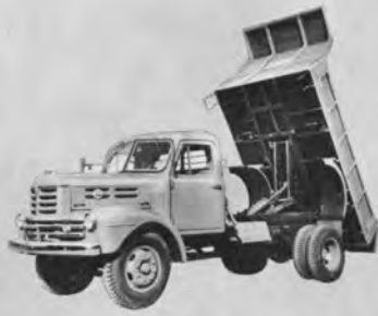
左：いすゞTX 352形 5t積ダンプトラック 昭和34年製
