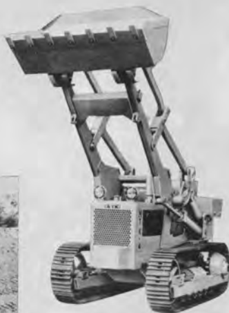
↑日特NTK-5形トラクタショベル 10.5t 山積1.2m 3 昭和44年製
