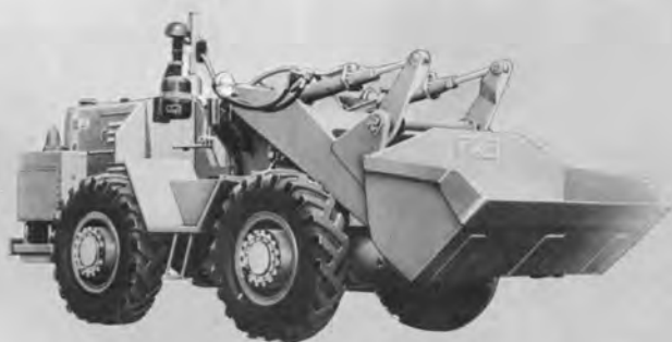
上：三菱WS20形トラクタショベル 8.8t 山積1.5m 3 昭和37年製
