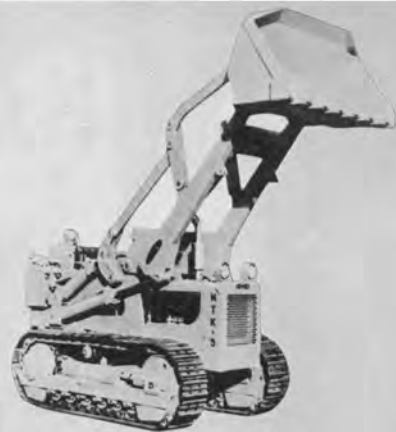
↑日特NTK-5形トラクタショベル 10.5t 山積1.2m 3 昭和44年製
