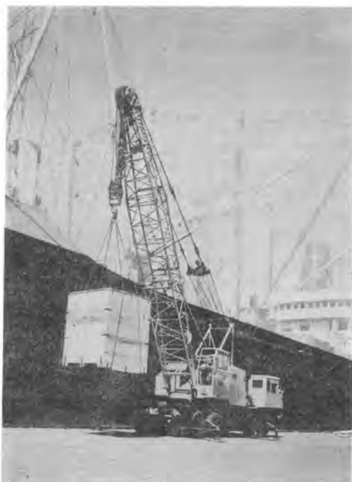
写真-1 F150 形 37t トラッククレーン
