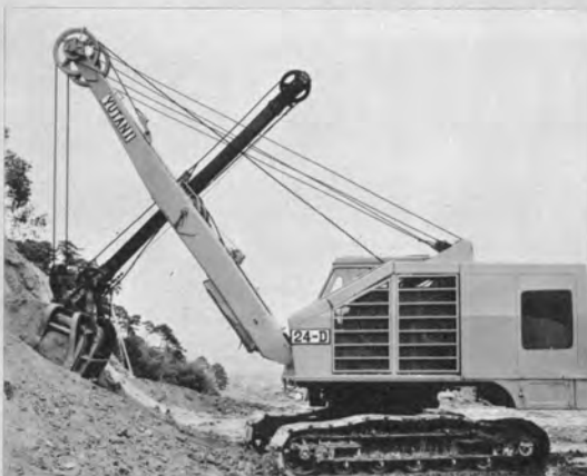
上：日立 U106 A 形ショベル デイックバ容量 0.6m 3 昭和44年製 右上：日立 U05 形ショベル デイックバ容量 0.5m 3 昭和24年製 右下：日立 U106 形ショベル デイックバ容量 0.6m 3 昭和32年製
