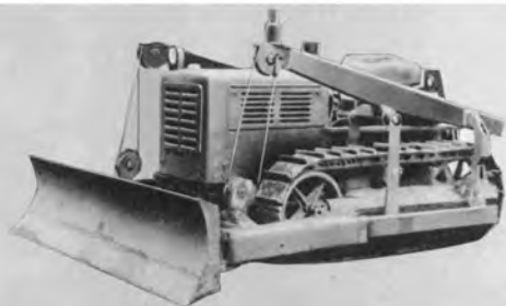
↑日特NTK-4形アングルドーザ 6t 昭和27年製
