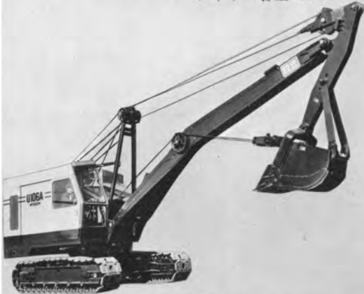
上：日立 U106 A 形ショベル デイックバ容量 0.6m 3 昭和44年製 右上：日立 U05 形ショベル デイックバ容量 0.5m 3 昭和24年製 右下：日立 U106 形ショベル デイックバ容量 0.6m 3 昭和32年製
