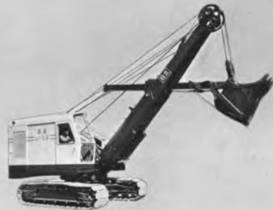
上：日立 U106 A 形ショベル デイックバ容量 0.6m 3 昭和44年製 右上：日立 U05 形ショベル デイックバ容量 0.5m 3 昭和24年製 右下：日立 U106 形ショベル デイックバ容量 0.6m 3 昭和32年製
