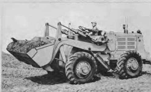
左上：三菱WS形トラクタショベル 9t 山積1.2m 3 昭和30年製
