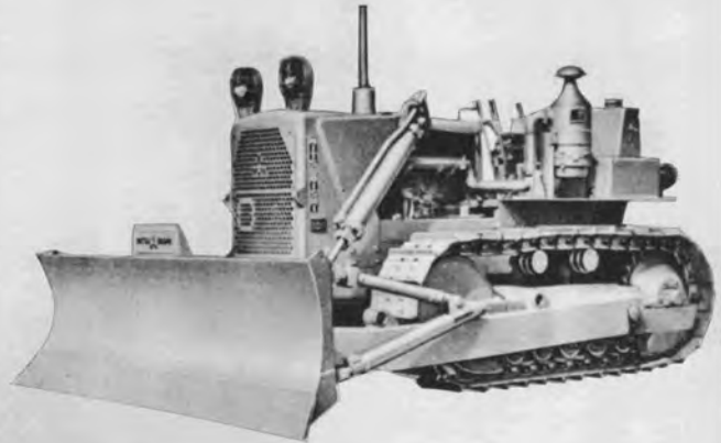
上：三菱BD11形ブルドーザ(油圧式) 11t 105PS 昭和39年製 左上：三菱BB II形アングルドーザ 9t 昭和24年製 左下：三菱BBIV形ブルドーザ 10.5t 75PS 昭和27年製
