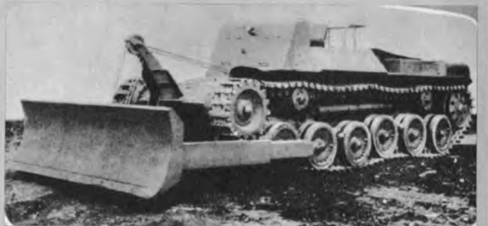
上：三菱BF形ブルドーザ 15.5t 95PS 昭和26年製 右上：三菱BD17形ブルドーザ(油圧式) 17t 140PS 昭和38年製 右下：三菱中戦車改造排土車 昭和20年製
