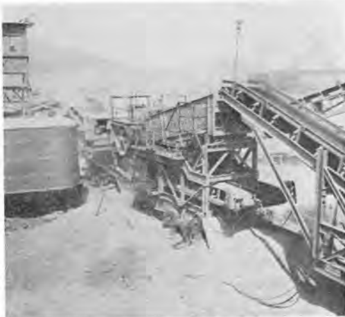
写真-2 過剰の細粉を除去する 53' x 12' ダブルデッキス キャルピングスクリーン (1 次ジョークラッ シャと同一のジャンに装架されている)
