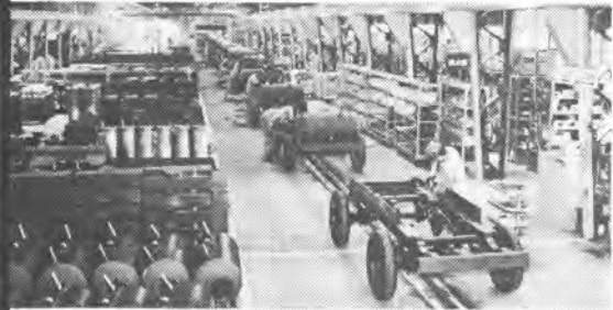
●200米コンベアラインの組立工場
