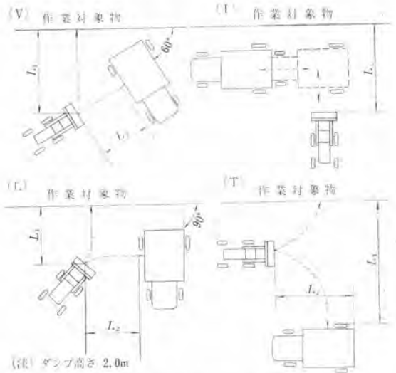
図-150.3 積込作業試験車両配置図
