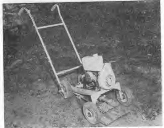
写真-3 板ばね方式ののり面締固め機
