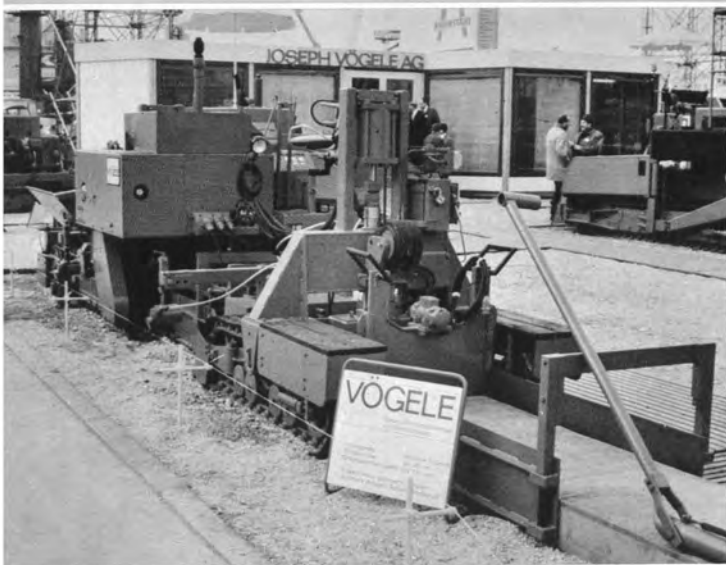
↑幅75 cm 厚さ35 cm まで舗設できる 側帯用スリップフォームペーパ
