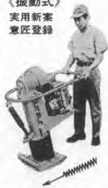
道路・水道・瓦斯管 電設工事・盛土・砕石・締固め VRA-120型 自重120kg VRA-80型 自重80kg VRA-60型 自重60kg
