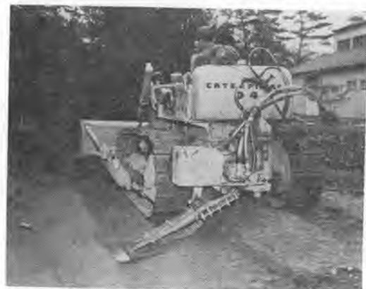
写真-2 ブルドーザに装着された板バネ方式ののり肩締固め装置
