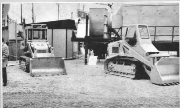
↑小形のトラクタショベル 土工機械は一般に中小形が多い
