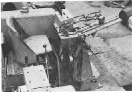
写真-5 のり面転圧機ののり装置
