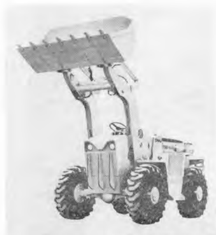
写真-2 装輪式トラクタショベル “134 AJ”
