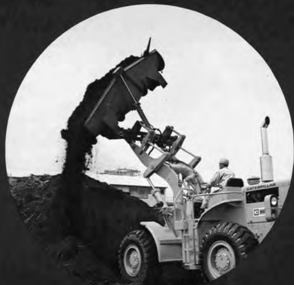
950 両サイドダンプバケット（左右両方への積込み）
