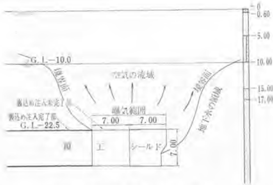
図-4 実際の圧気シールドの漏気状況
