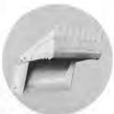
● マルチパーパスバケット 一般の積込み作業の他のり切り スクレープ くわえ込みなど多目的に。
