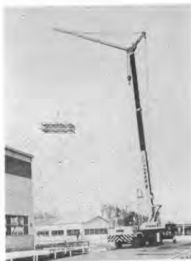
写真-1 NK-20 A テレタワー・トラッククレーン作業姿勢
