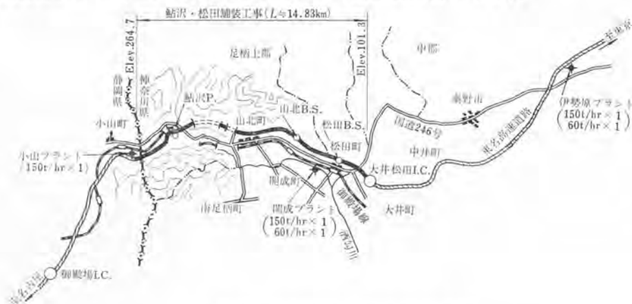
図-1 鮎沢～松田舗装工事区間位置図
