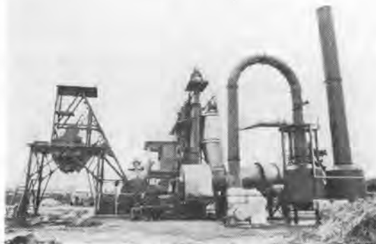
写真-2 三井三池 WST-50 M 形アスファルトプラント
