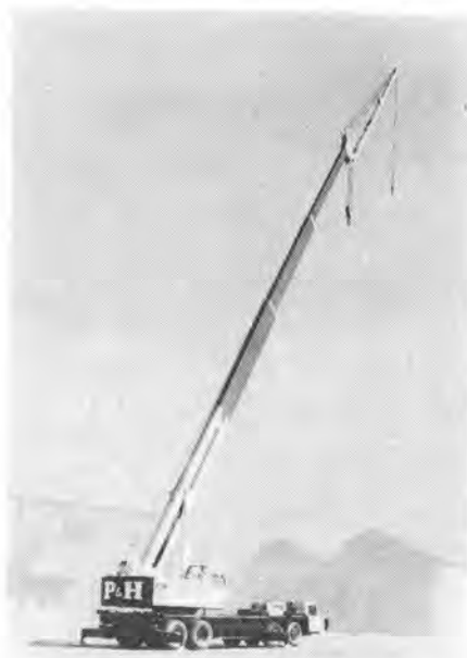
写真-5 油圧式クレーン "T 600"
