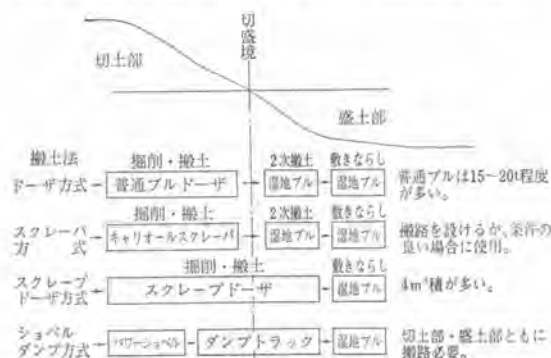
図-6 関東ローマの施工方法
