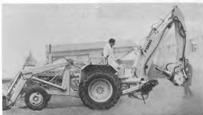
↑ 油圧式ブレーカを装備したホイールローダ 油圧式ブレーカを装備したホイールローダで、コンクリートや原石の破碎を行ない、破砕片をローダによって運搬と積み込みができる。
