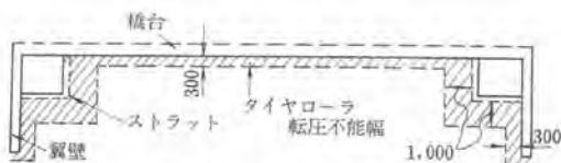
(a) 25t級タイヤローラ転圧不能箇所
