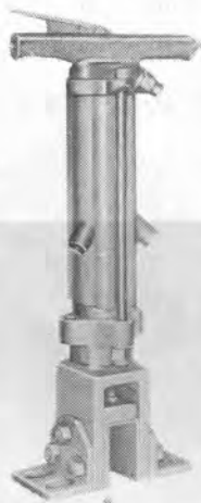
■シートパイルドライバー
