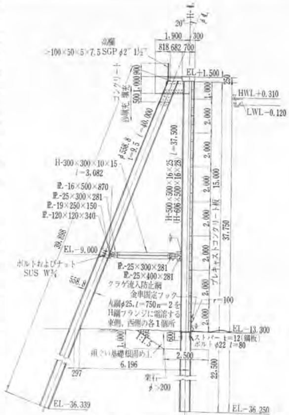
図-7 組ぐい標準断面図(側面)
