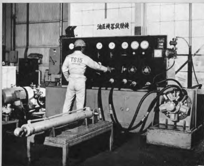
←油圧機器総合テストスタンド 油圧機器整備の信頼性と品質の向上をはかるためそれらの性能試験に使用する。またポンプ、モータ、バルブ、シリンダ等の総合試験ができる。
