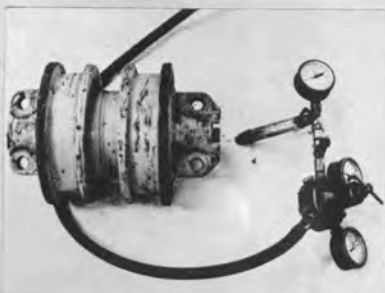
←ローラ・シール洩れの検査具 空気圧(足踏みポンプでも可)の利用により本体組付け前にテストして油洩れの早期発見ができる。
