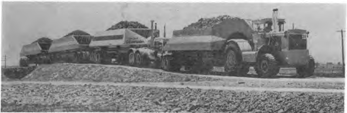
写真-1 巨人ダンプトレーラ “The Four” (コンバートローリを連結したもの)
