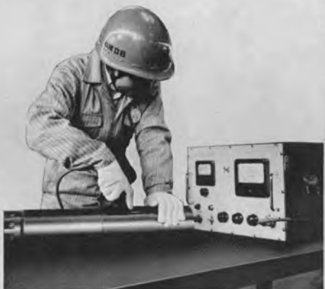
↑亀裂深度計 部品の亀裂の検出には電磁探傷、カラーチェック、超音波、X線等があるが、深さを測るには亀裂深度計を用いて交換か加修かの判定を行なう。
