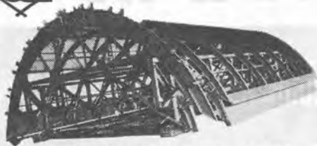
山陽新幹線上半スライドセントル
