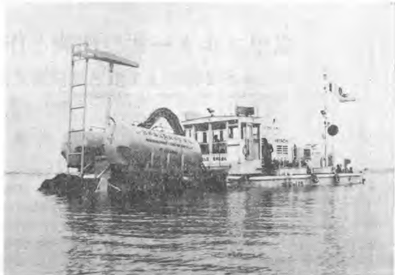
写真-1 浜名湖における水中ブルドーザ (S-2 形)
