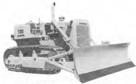
写真-2 日立 T20 ブルドーザ
