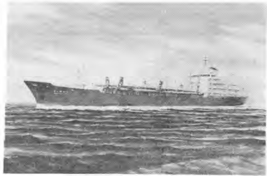
写真-5 ドラグサクシオン浚渫船“第1特浚丸”
