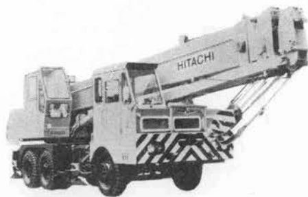
写真-2 油圧式トラッククレーン“FH 80”
