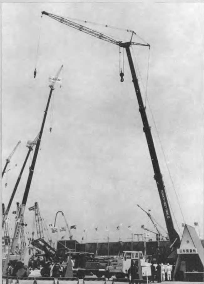
▲空に幾何模様を切る油圧クレーン伸縮ブーム(日鋼、多田野)
