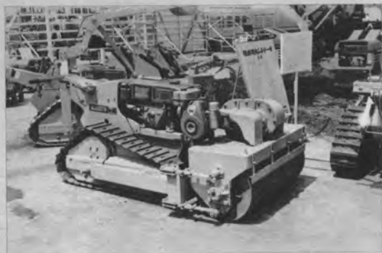
▲振動ローラにもなるハンドドーザ (久保田鉄工)
