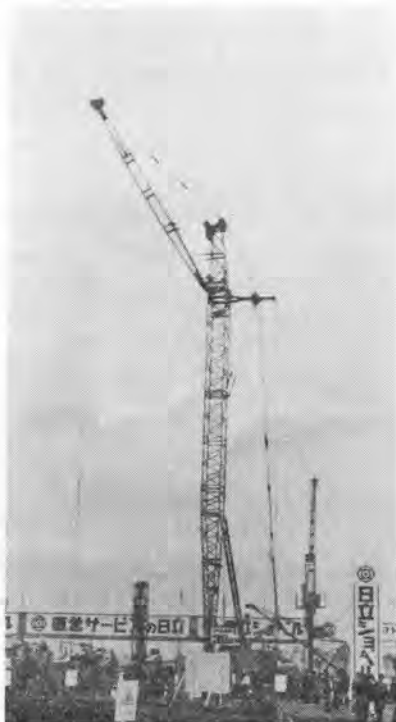
36m ブームをもつクローラ式タワークレーン(日立 U106 ASL)
