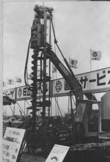
▲油圧ショベル本体に装着した油圧式アースオーガ(日立、三和)
