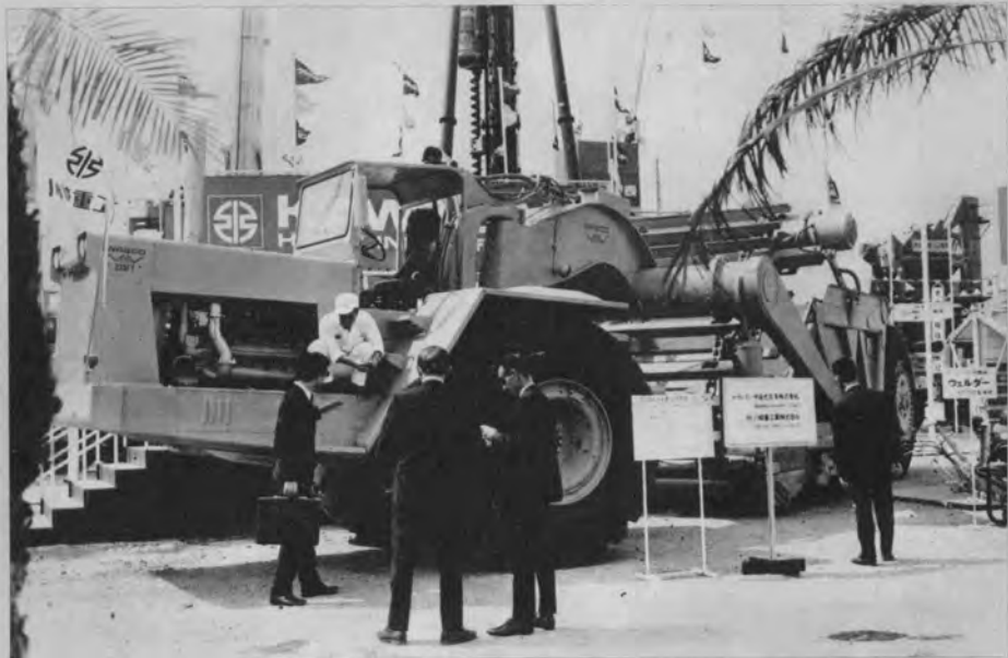
▲プッシャ不要の大形エレベータリングスクレーパ (WABCO B333FT 川崎重工)
