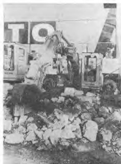
ロックブレイカ付油圧バックホウ (加藤 HD 350)
