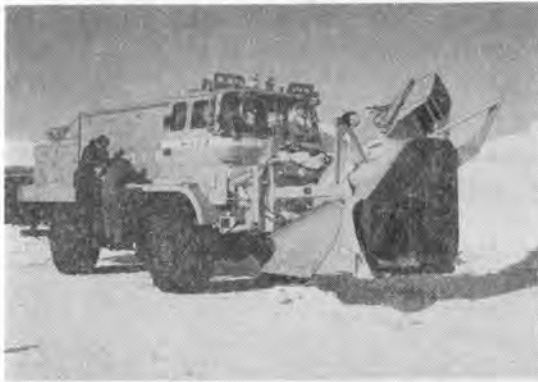
写真-10 高速ロータリ除雪車 (800 PS)
