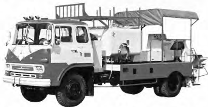
三菱シュベック・コンクリートポンプ車 ダイヤモンド100
