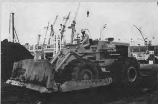
▼日本化された広幅タイヤドーザ(東洋運搬機220)
